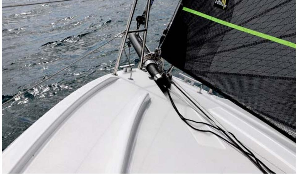
De bons cale-pieds pour manœuvrer en sécurité sur la plage avant. Une cavité logée dans le pont permet le rangement du bout-dehors.
