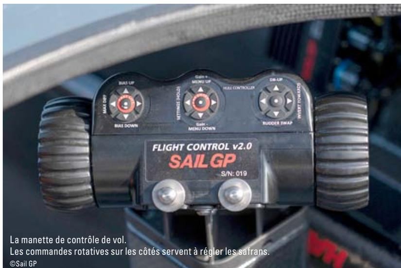
La manette de contrôle de vol. Les commandes rotatives sur les côtés servent à régler les safrans.
