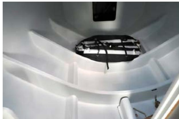
Les couples sur la section avant et le contremoule collé autour de la quille. Une structure très bien renforcée.
